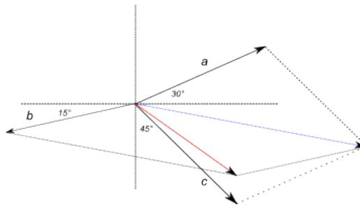
*Caso 1.* (b): l'operazione  $\vec{a} - \vec{b}$  si esegue sommando al vettore  $\vec{a}$ , l'opposto del vettore  $\vec{b}$  (in verde in figura). La somma eseguita graficamente è mostrata in figura
