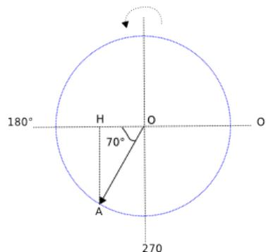
**Soluzione.** La determinazione delle componenti di un vettore si basa sulle definizioni delle funzioni goniometriche. (Si veda la figura) Il vettore è rappresentato da  $\vec{v} = OA$ ; la componente orizzontale  $v_x$  è rappresentata dal segmento  $OH$  (proiezione di  $OA$  sull'asse  $x$ ), che nel piano cartesiano ha verso negativo. Il coseno dell'angolo formato dal vettore con l'asse  $x$  è, per definizione,
