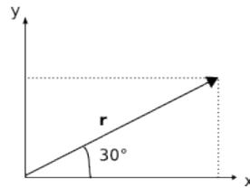
**Soluzione.** In questo caso il calcolo delle componenti può essere eseguito semplicemente ricordando che il triangolo avente come cateti le componenti e come ipotenusa, il vettore, è la metà di un triangolo equilatero, il cui lato è lungo quanto il modulo del vettore  $r$ . Pertanto la componente verticale  $r_y = 15 : 2 = 7,5 m$ , mentre la componente orizzontale è l'altezza di questo triangolo, per cui  $r_x = \frac{15 m \cdot \sqrt{3}}{2} = 13 m$
